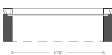
Imagem 298 - Levantamento gráfico da Janela V10 - Planta - Escala 1:25
