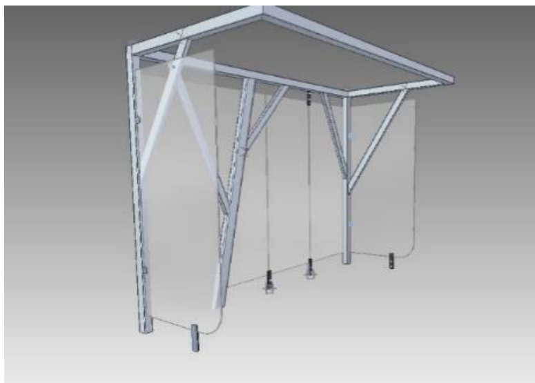
Figura 71 - Boleado do vidro lateral
