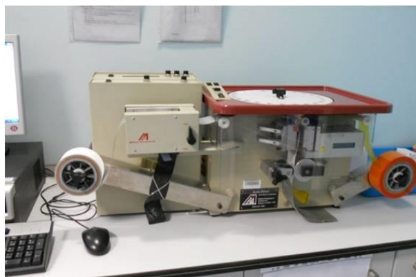
Figura 3 - Máquina Semiautomática de Reembalagem (Auto-Print Unit Dose Systems - MPI)
