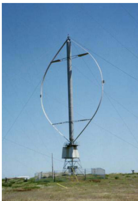
Figura 2.9. Turbina Darrieus (extraído de [13]).
