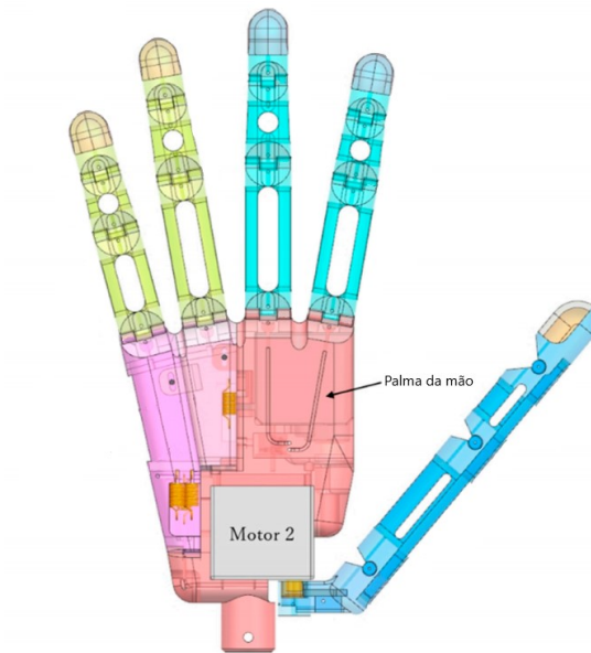
Figura 50: Posicionamento do motor (Yong et al., 2019)
