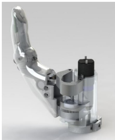
Figura 54: Polegar desenvolvido por (Losier et al., 2011)
