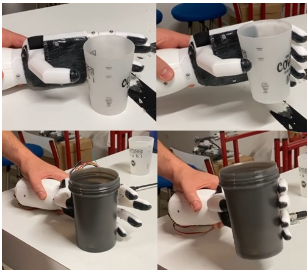
Figura 128: Teste de diferentes tipos de copos
