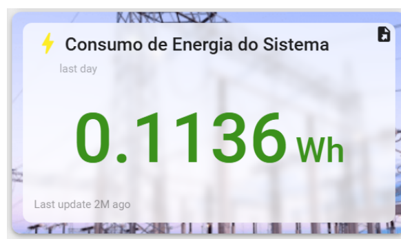
Figura 5.10: A imagem representa o dashboard de estimativa do consumo energético do sistema. O dashboard é responsável por exibir o consumo energético estimado do sistema IoT, com base em parâmetros como tempo de atividade, utilização do processador e comportamento do sensor.
