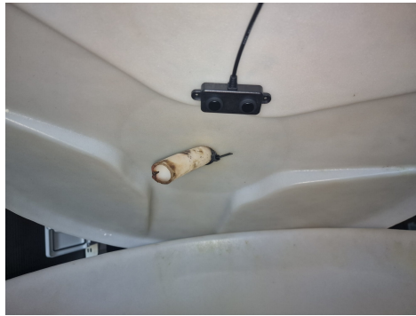
Figura 5.13: Representação do sensor ultrassónico instalado na tampa do tanque, orientado diretamente para baixo.
