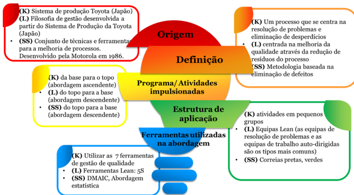
Figura 28: Fluxograma dos conceitos de Kaizen , Lean e Seis Sigma [37].
