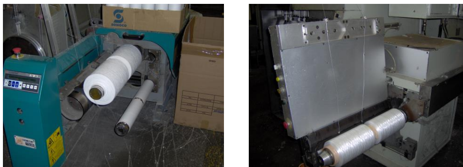
Figura 11 – Partes de máquinas sem protecção
