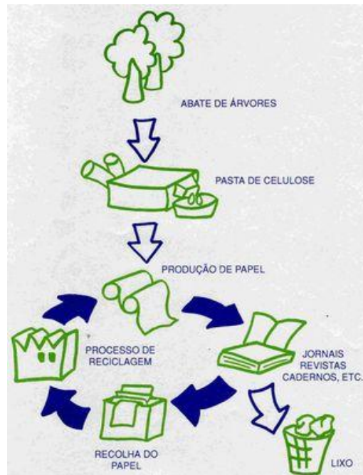
Figura 5: Processo de reciclagem do papel.
