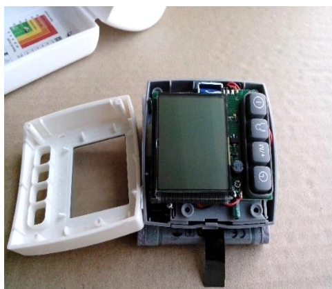
Figura 76 - Medidor sem tampa
