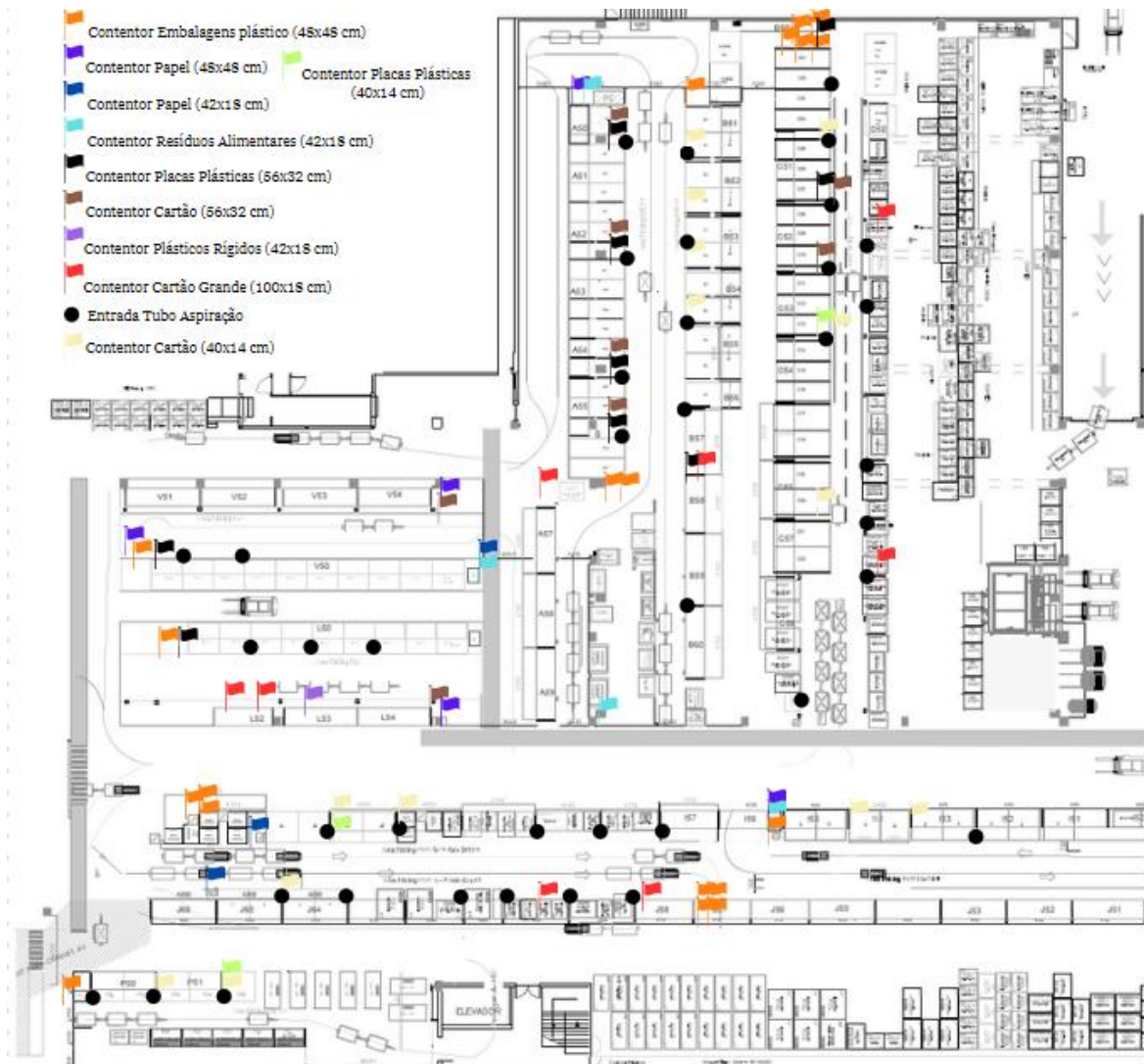
Figura 19- Mapa de contêntores dos resíduos das zonas do picking e entradas dos tubos do sistema de aspiração
