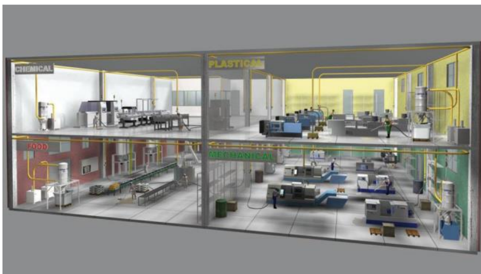
Figura 3- Sistema de Aspiração Centralizada (Álvarez, 2013)
