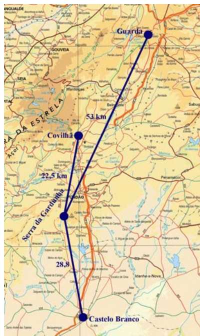
Fig. 11. Ligações ponto-a-ponto entre a Covilhã e Castelo Branco e a Covilhã e Guarda, com repetidor na Serra da Gardunha.
