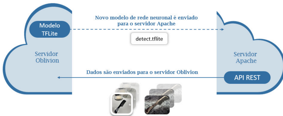
Figura 6.3: Envio de dados entre o Servidor Apache e o Servidor Oblivion.
