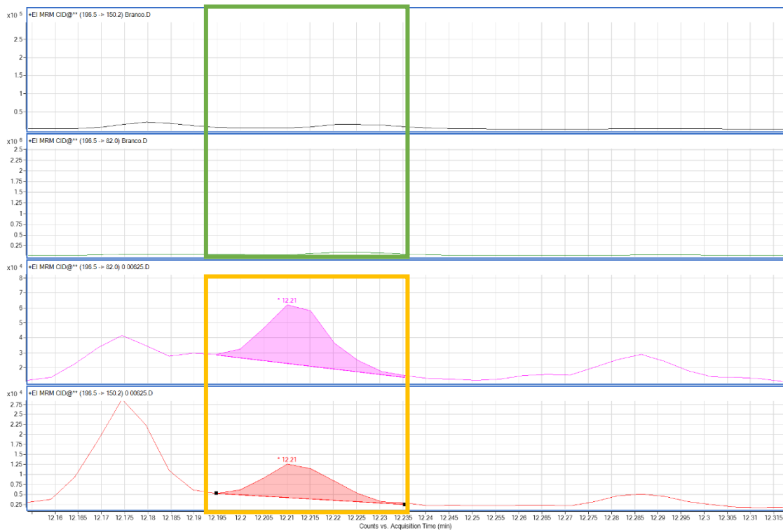
Figura 25 - Cromatograma de uma amostra branco vs o LOQ para o COET.
