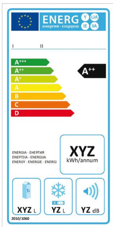
Fig. 2.2 - Etiqueta uniforme para os aparelhos de refrigeração de classe D até A+++
