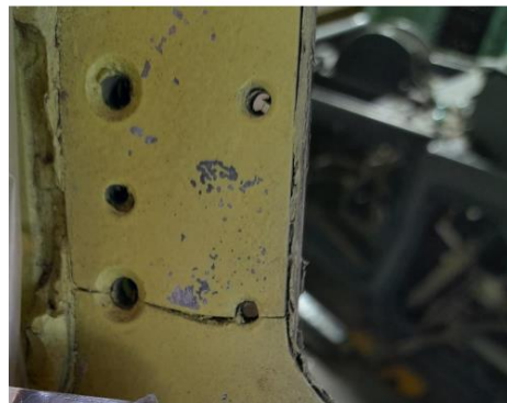
Figura 10: Exemplo de fissura no C-130 localizada no cockpit
