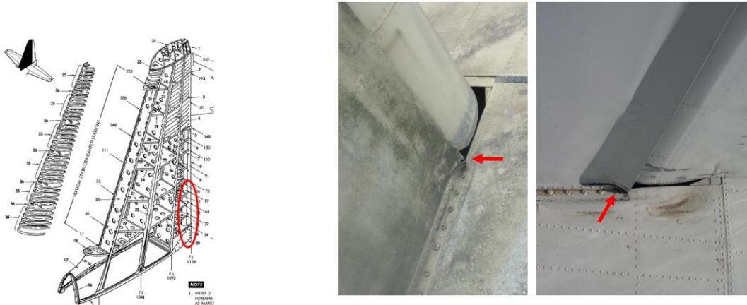
Figura 11: Exemplo de uma deformação da casca do C-130 localizada no estabilizador vertical
