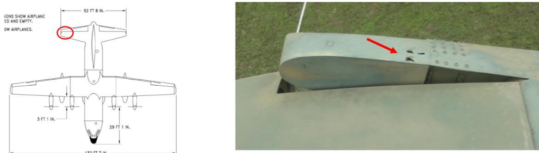
Figura 6:Exemplo de corrosão do C-130 localizada no estabilizador horizontal
