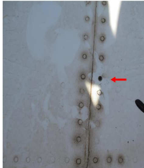
Figura 13: Exemplo da falta de um rebite do C-130 localizada perto do bordo de fuga da asa
