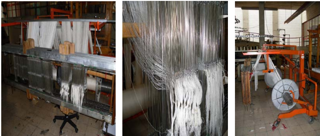
Figura 28 - Etapas da preparação à tecelagem
