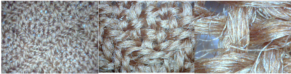
Figura 39 - Experimento 1: fios grossos de lã com urdume e trama de mesma cor. Fonte: Autora.
