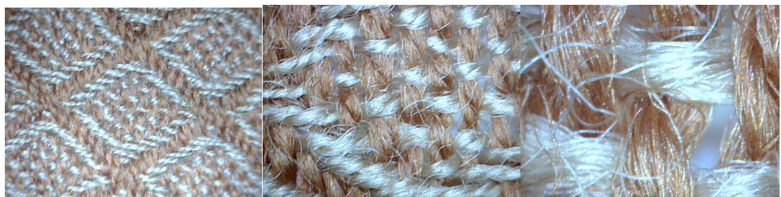
Figura 42 - Experimento 4: fios grossos de lã no urdume e fios mais finos na trama, em cores diferentes. Fonte: Autora.
