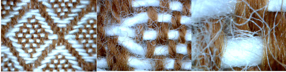
Figura 43 - Experimento 5: fios grossos de lã no urdume e fios de algodão na trama, em cores diferentes. Fonte: Autora.
