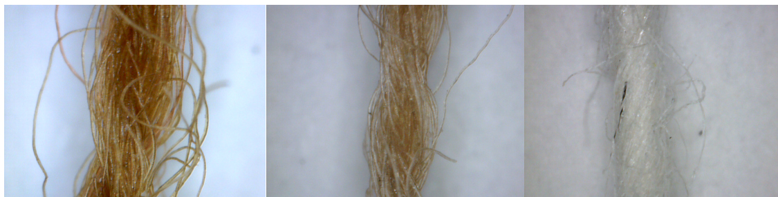
Figura 29 - Os fios de lã 2/32Nm, 2/64 Nm e o algodão 8Ne com ampliação de duzentas e dez vezes. Fonte: Autora.
