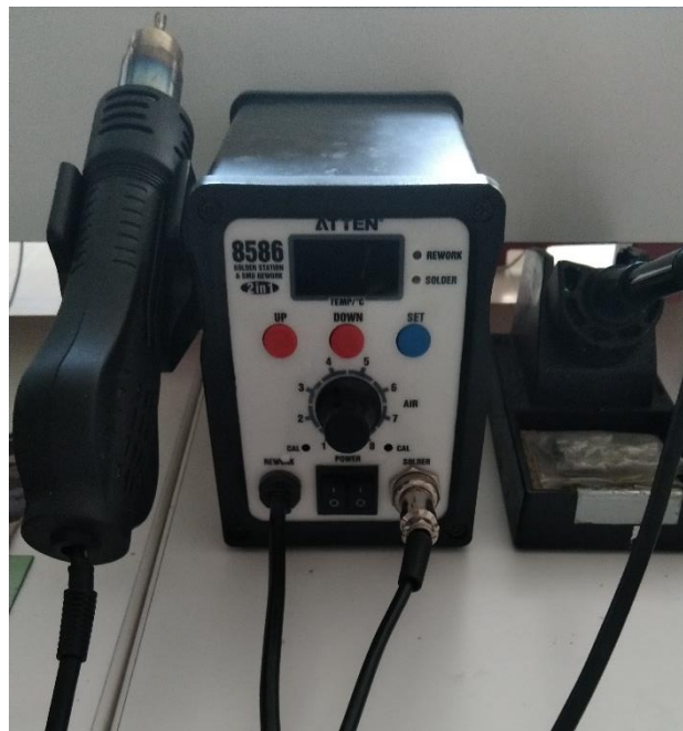
Figura 27- Estação de solda ATTEM 8586 utilizada na atividade experimental.
