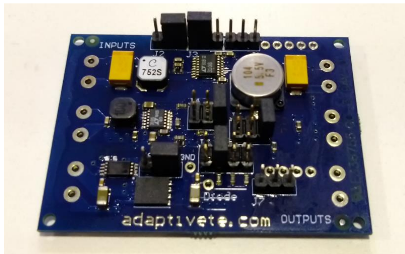
Figura 25- Sistema de Captação de energia: Kit ADEH-K-A da Adaptive Power Management.
