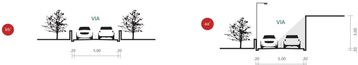
Figura 50 Cortes Rua das Cerâmicas
