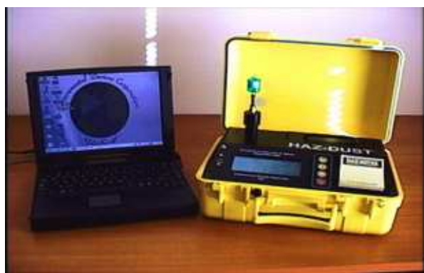
Figura 57 - Monitor de partículas PM 10 , modelo EPAM 5000, marca EDC. [57]
