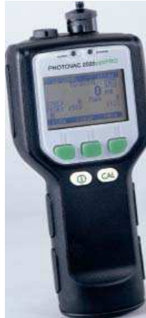
Figura 58 - Monitor de COV's, modelo 2020 ppb-PRO, marca Photovac. [57]
