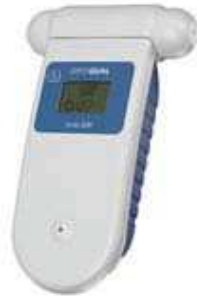
Figura 60 - Monitor portátil de ozono, série 200, marca Aeroqual. [57]
