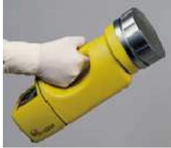
Figura 62 - Amostrador microbiológico de ar ambiente da marca PBI. [57]
