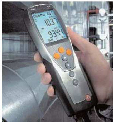
Figura 61 - Monitor Multifunções, para QAI e VAC modelo 435-2, marca Testo, com sonda QAI ( \text{CO}_2 , temperatura e humidade) e sonda de CO. [57]
