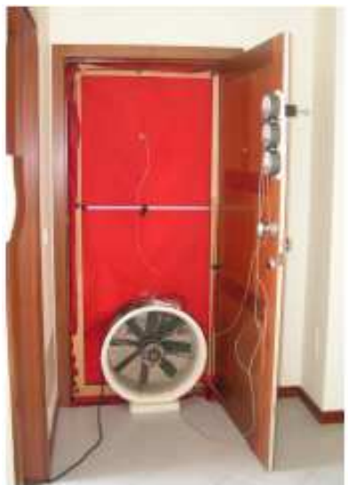
Figura 52 - Exemplo de uma porta ventiladora. [10]
