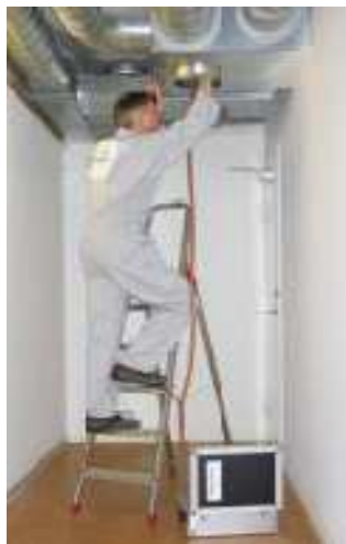
Figura 63 - Equipamento para determinação do grau de limpeza das condutas de ar, CLEAN TEST, marca ROBIMECH. [57]
