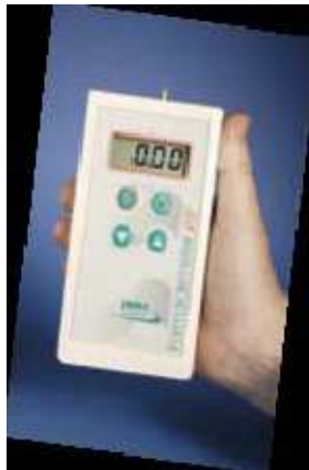
Figura 59 - Monitor portátil de formaldeído, modelo Formaldemeter htv, marca PPM. [57]
