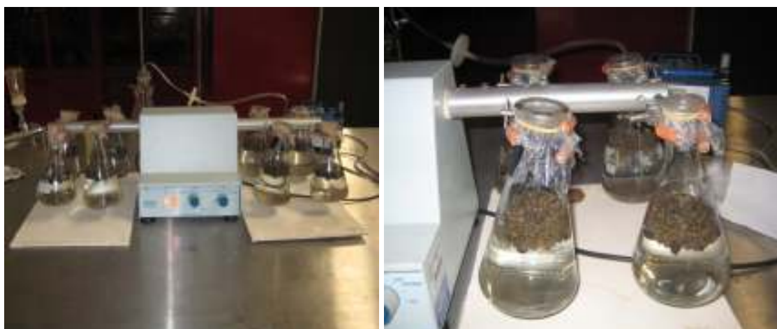
Figura 5.3. Ensaio de adsorção no Flask Shaker
