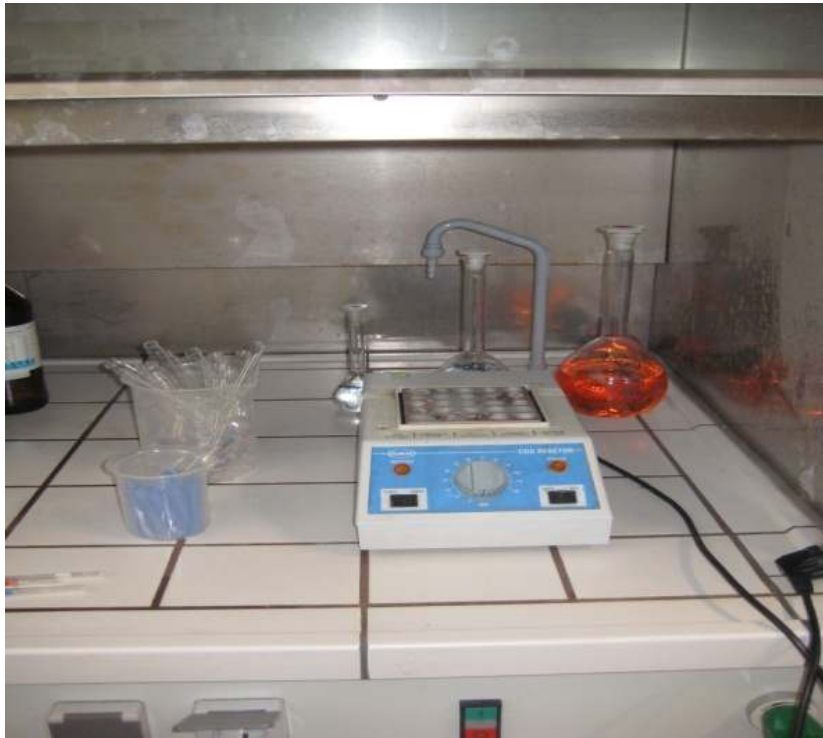
Figura 5.4: Digestor, onde ocorre a oxidação da amostra em refluxo fechado
