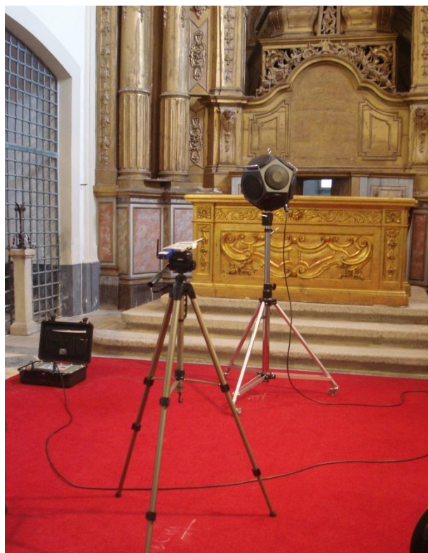
Fig. 47 Equipamento de medição acústica na capela-mor da Igreja do Mosteiro de São Bento de Cástris (fotografia da autora)
