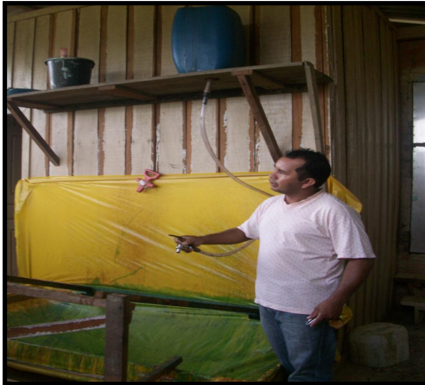
Figura 17- A resina é depositada em um galão de plástico na parte superior da mesa de banho e com uma mangueira é realizado o processo de impregnação sobre a tela.
