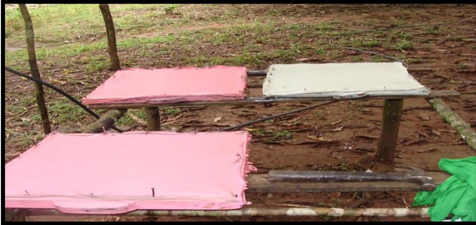
Figura 12- O processo de pós-cura onde o sol agirá evaporando o que resta de água do látex reforçando as ligações cruzadas entre agente de cura e polímero
