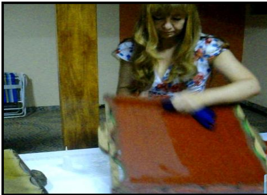
Figura 13- A aplicação do silicone a base de água dará ao compósito o brilho final, neste momento poderá utilizar agentes eliminadores de odor, caso opte não usá-lo na formulação
