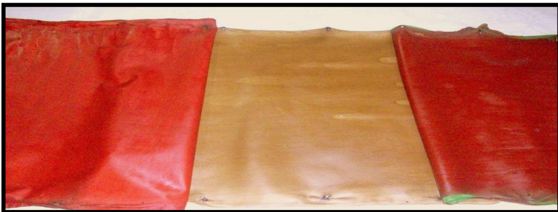
Figura 14- Compósito final vermelho com pigmento artificial e amarelado com madeira Breu
