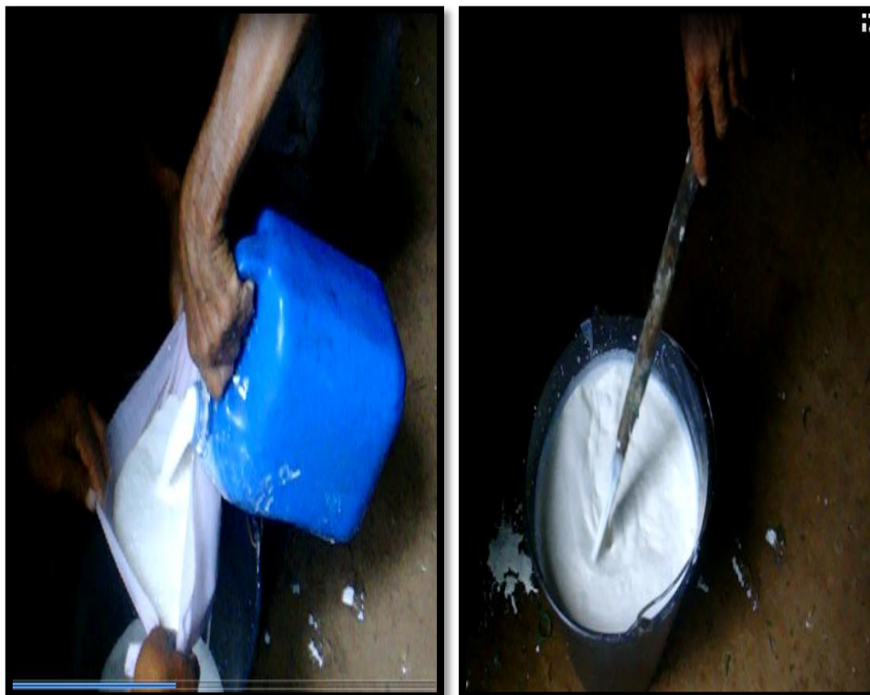
Figura 6 O látex após a coleta é coado para eliminar qualquer impureza, sendo aditivado agente antioxidante e em seguida os aditivos vulcanizantes. Quando há uso de corantes este é incorporado
