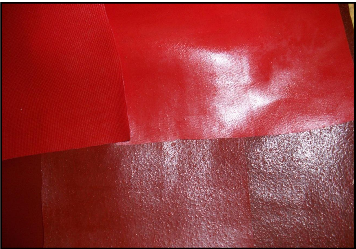
Figura 15-Compósitos em uma base de malha vulcanizados no sol
