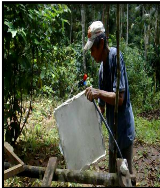
Figura 11- Nesta etapa a lavagem apenas retira pequenas impurezas superficiais que não aderiram completamente, o contato manual causa deformidade porque ainda possui certa plasticidade
