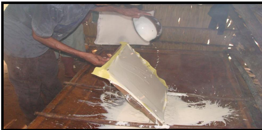
Figura 8- A aplicação do látex sobre a tela é a tarefa que exige maior agilidade do seringueiro, devido à facilidade de formação de bolhas de ar da resina que acarretam defeitos e irregularidades no compósito
