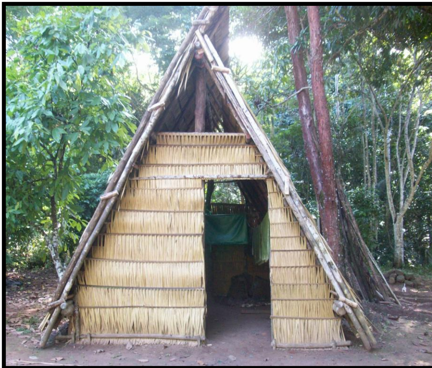
Figura 4- Típico tapurí para defumação da manta - As paredes são mais fechadas que um tapurí convencional, para evitar a entrada de insetos que são atraídos ao látex e se unidos à resina produzirá um material de menor qualidade
