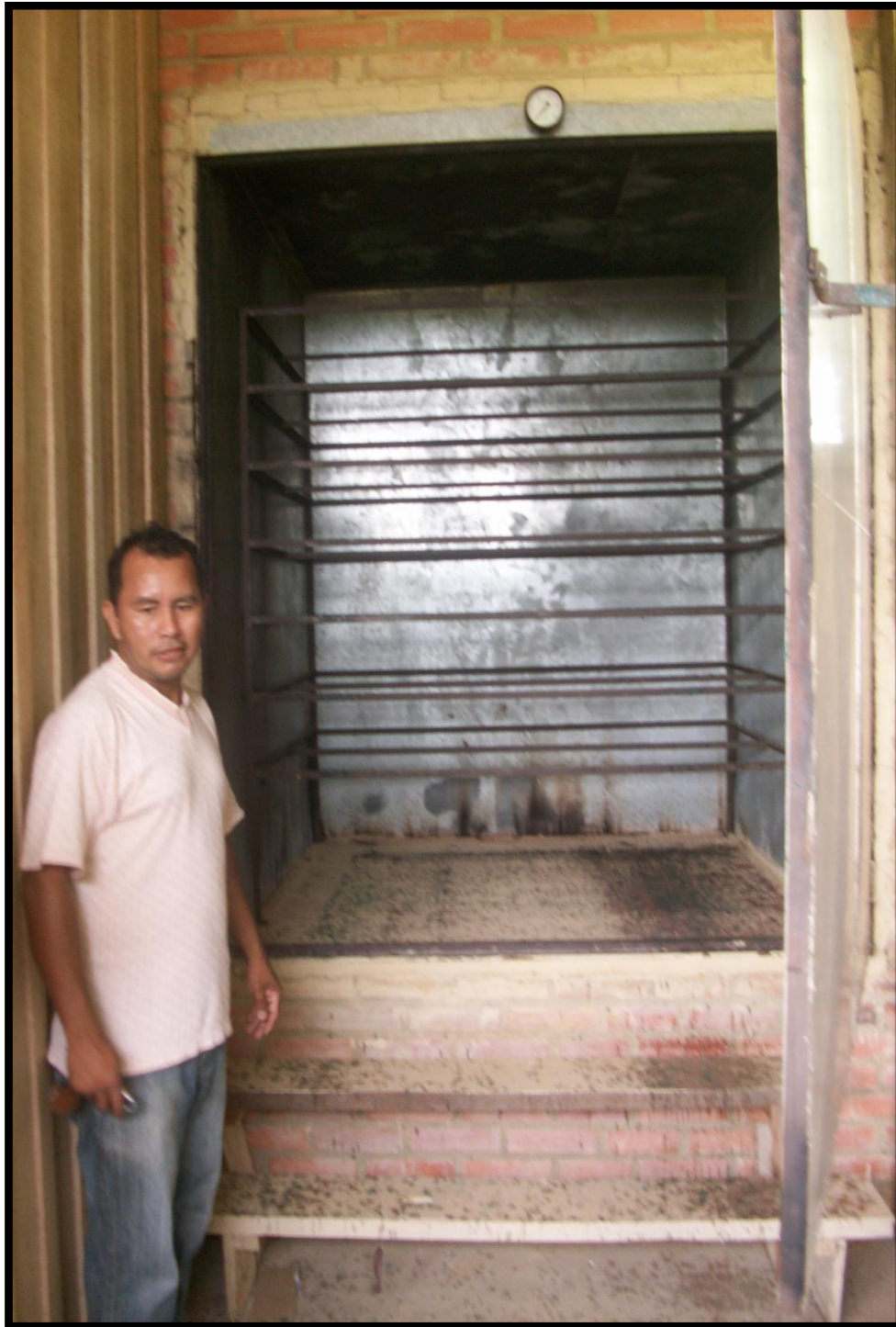
Figura 19- O forno tem capacidade para sete mantas ao mesmo tempo e um termômetro possibilitando controle de temperatura.
