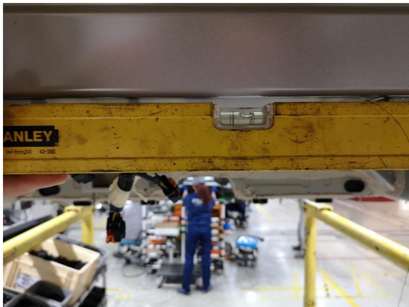
Figura 28 - Medição do Nivelamento no Eixo Traseiro
