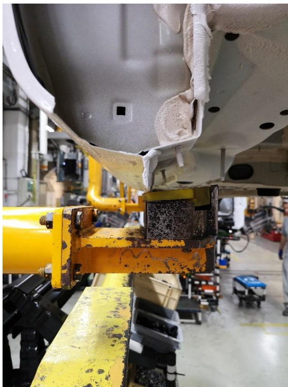
Figura 29 - Transportador Apanha a Carroçaria no Limite do Suporte
