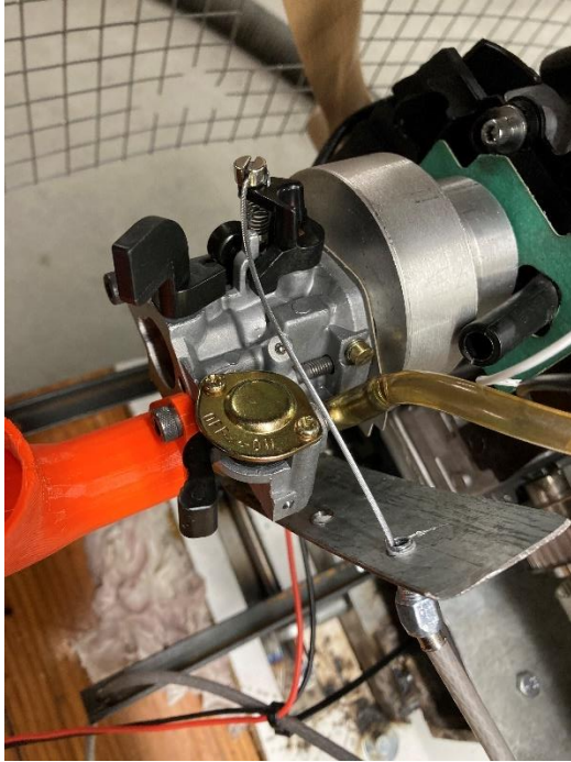
Figura 49 - Estrutura em alumínio usada para conectar o novo carburador à admissão do motor
