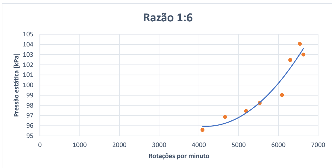
Gráfico 9 - Caracterização da pressão estática do motor com razão de polias 1:6
