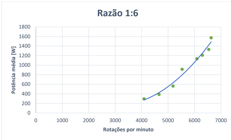
Gráfico 13 - Caracterização da potência média do motor com razão de polias 1:6
