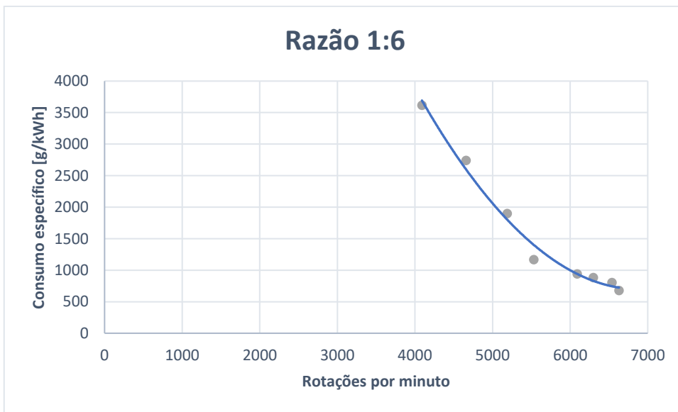
Gráfico 17 - Caracterização do consumo específico do motor com razão de polias 1:6
