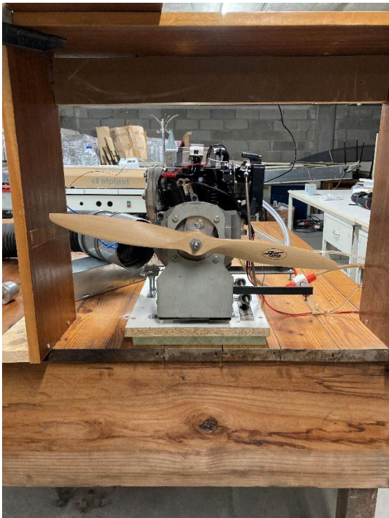
Figura 36 - Hélice 19x8 usada durante todos os ensaios
