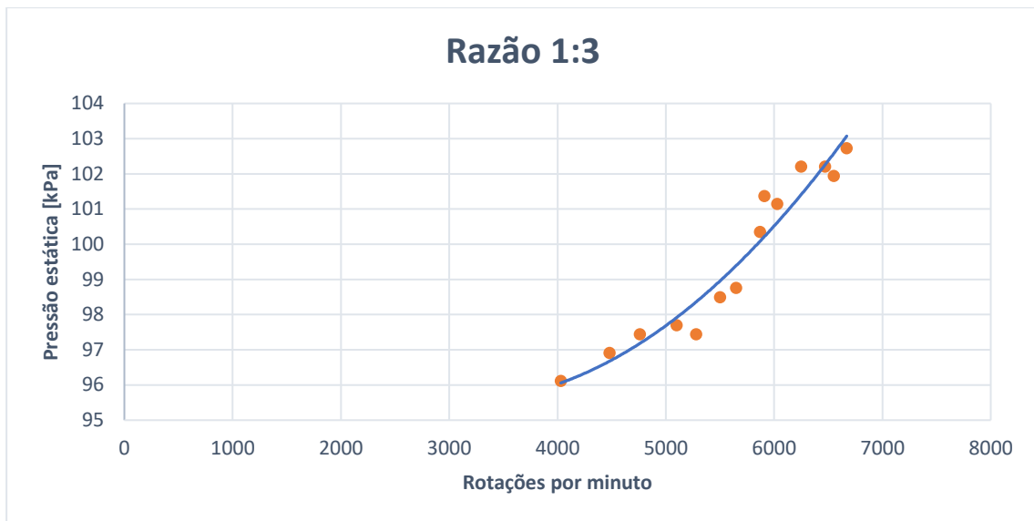
Gráfico 8 - Caracterização da pressão estática do motor com razão de polias 1:3
