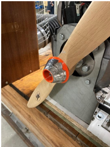
Figura 46 - Estrutura cônica impressa em 3D para arrancar o motor
