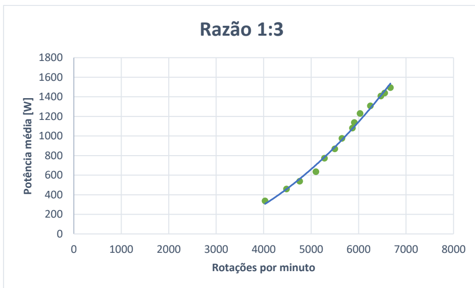
Gráfico 12 - Caracterização da potência média do motor com razão de polias 1:3
