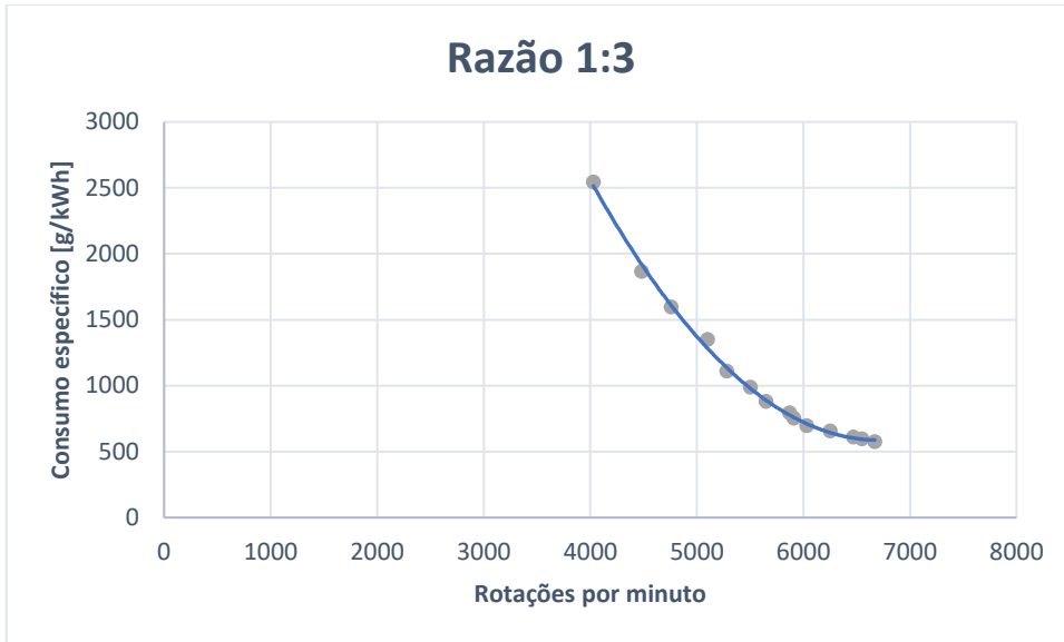
Gráfico 16 - Caracterização do consumo específico do motor com razão de polias 1:3
