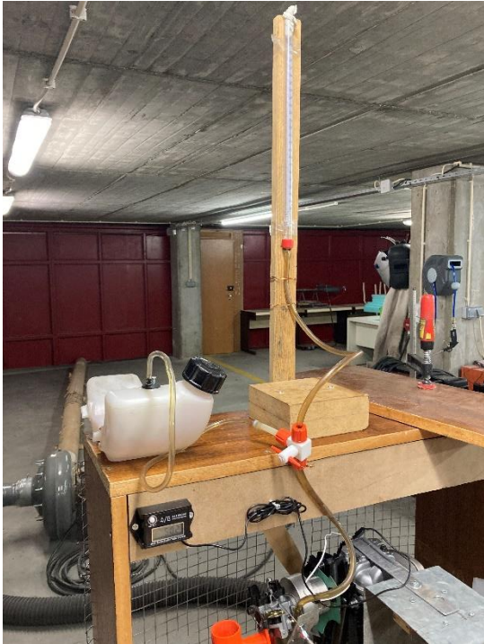
Figura 39 - Pipeta usada para medição do consumo específico do motor em todos os ensaios
