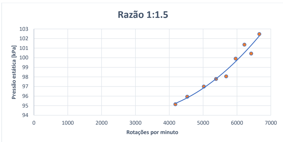
Gráfico 7 - Caracterização da pressão estática do motor com razão de polias 1:1.5
