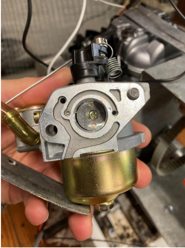
Figura 48 - Carburador G100 GXH50 Petrol Engine usado em vários ensaios
