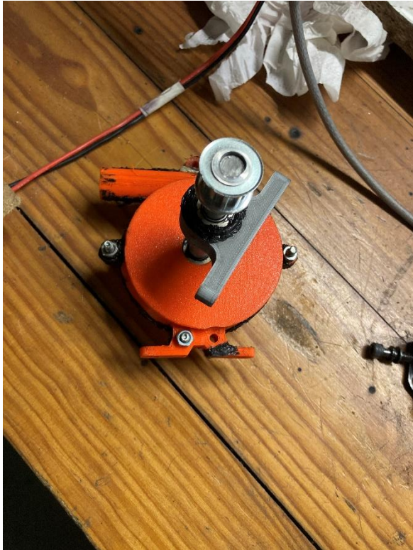
Figura 41 - Compressor centrífugo conectado a uma polia
