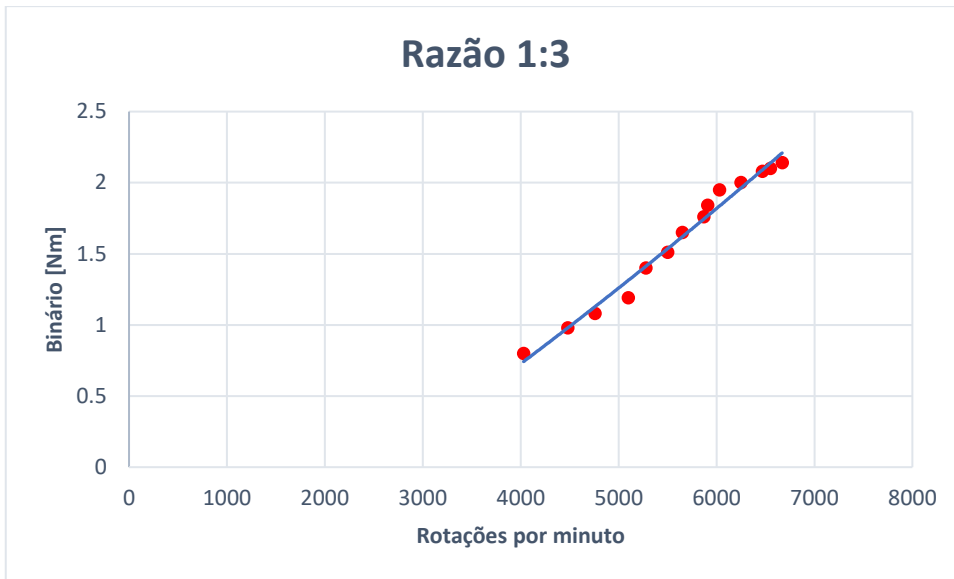
Gráfico 3 - Caracterização do binário do motor com razão de polias 1:3
