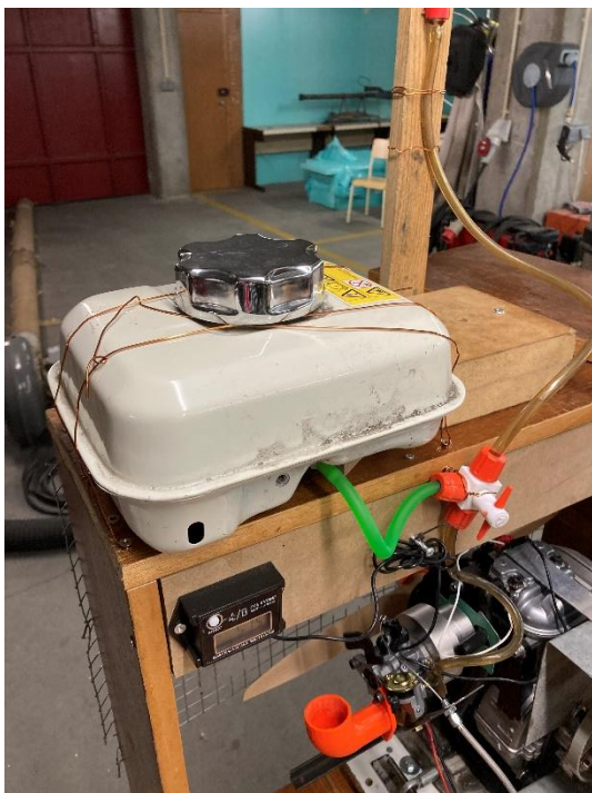
Figura 51 - Novo depósito de combustível usado durante os ensaios
