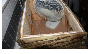
Fig. 2: Ecocasa aberta com ventilação forçada
