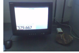
Fig. 5: Aquisição de contagens, com contador GM, da radiação emitida pela rocha
