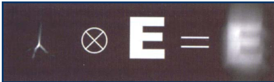
Figura 1.18. Construção da imagem como resultado da aplicação da função de convolução a cada ponto objecto. (Reproduzido de “Wavefront Customized Visual Correction”, The Quest for Super Vision II, Ronald, R. Krueger; Raymond A. Applegate; Scott M. MacRae, Editora SLACK Incorporated, 2004)
