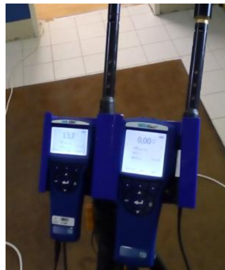
Figura 4.2.1.2 - Leitura de cov's no interior do edifício
