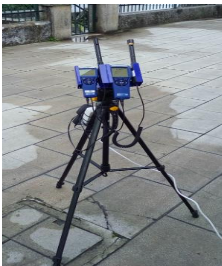
Figura 4.2.1.1 - Leitura de cov's no exterior do edifício
