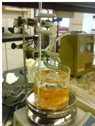
Figura 3.2. Solução de aminonaftol ao fim de 6h de agitação
