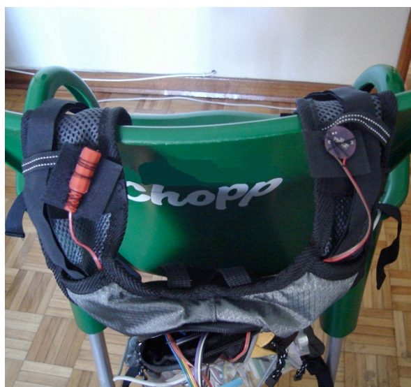
Figura 35: Montagem dos vibradores.
