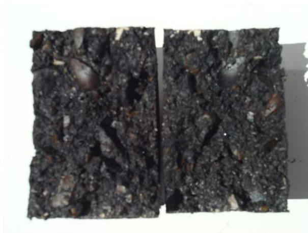
Figura 4. 42: Interior de um provete de laboratório do grupo “molhado”, após ensaio à tracção indirecta.
