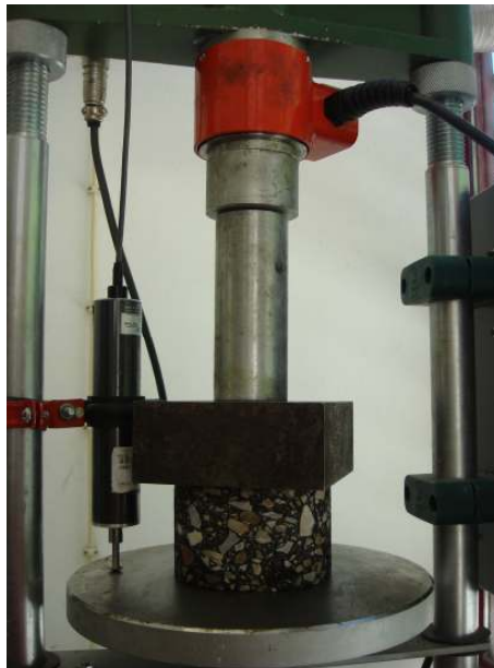
Figura 4. 49: Ensaio de compressão a um carote de obra.
