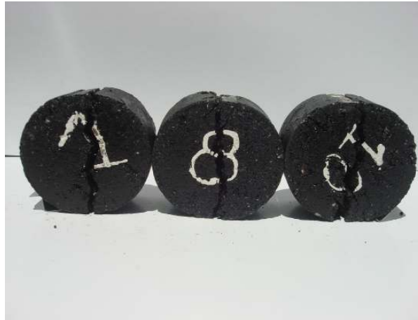
Figura 4. 14: Fracturas resultantes nos provetes de laboratório do Grupo 1, após o ensaio de tracção indirecta.
