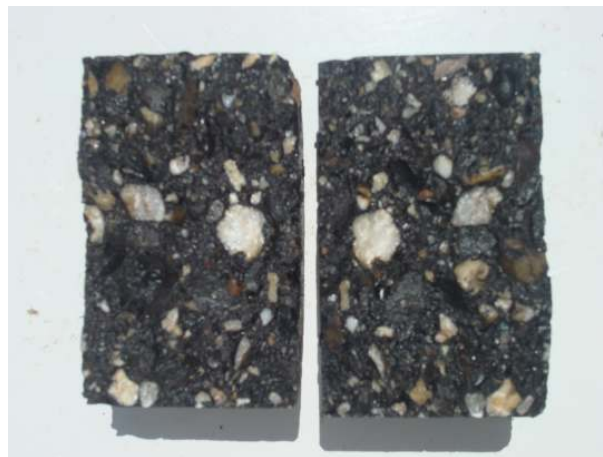
Figura 4. 25: Interior de um provete do Grupo 3, após o ensaio de tracção indirecta.
