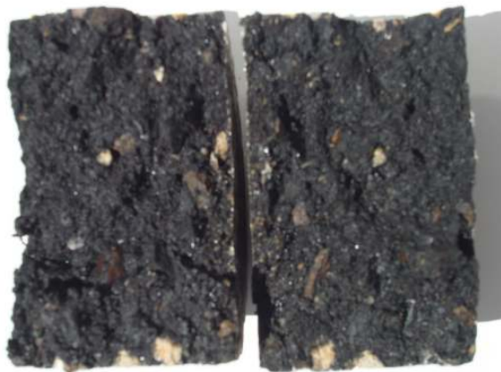
Figura 4. 35: Interior de um carote do Grupo 5, após o ensaio de tracção indirecta.
