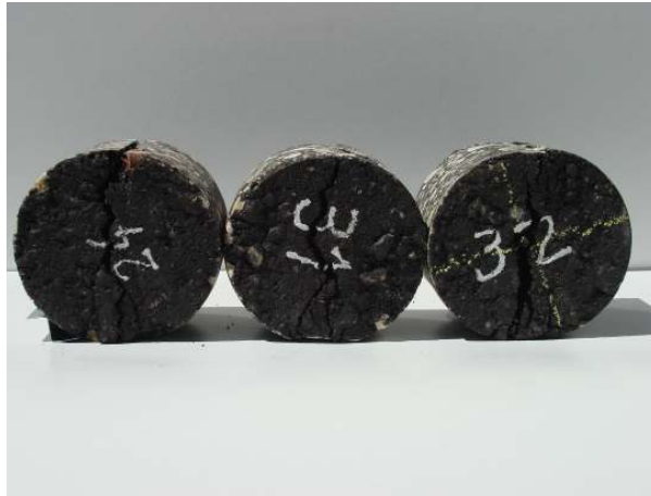
Figura 4. 43: Fissuras de cada carote de obra do grupo “seco”.
