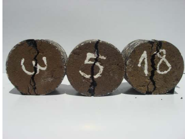
Figura 4. 30: Fracturas resultantes nos carotes do Grupo 4, após o ensaio de tracção indirecta.
