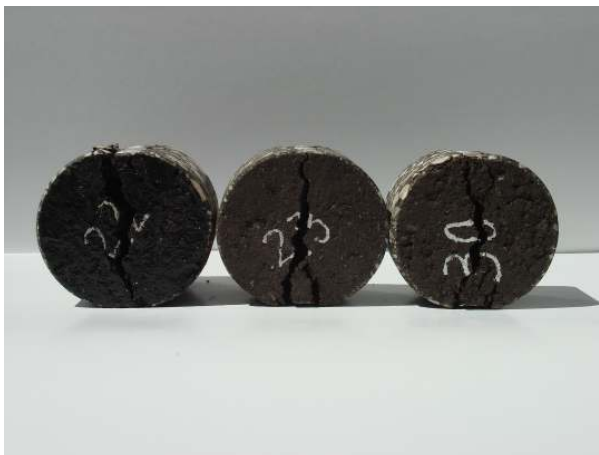
Figura 4. 45: Fissuras de cada carote de obra do grupo “molhado”.
