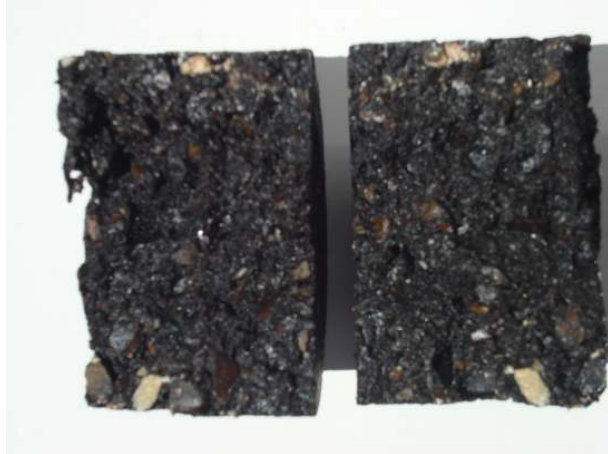
Figura 4. 33: Interior de um provete do Grupo 5, após o ensaio de tracção indirecta.
