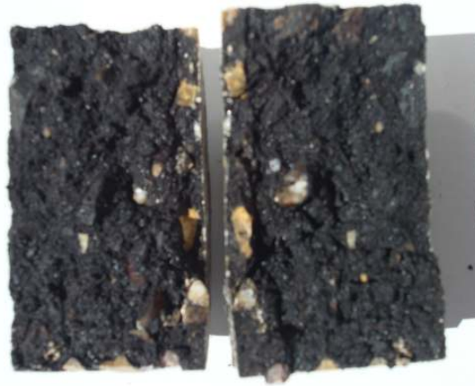
Figura 4. 46: Interior de um carote de obra do grupo “molhado”, após ensaio à tracção indirecta.
