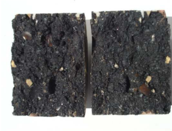
Figura 4. 44: Interior de um carote de obra do grupo “seco”, após ensaio à tracção indirecta.
