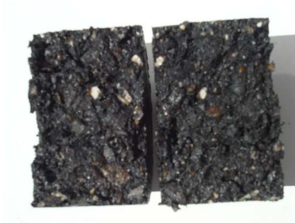
Figura 4. 40: Interior de um provete de laboratório do grupo “seco”, após ensaio à tracção indirecta.
