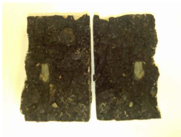
Figura 4. 17: Interior de um carote do Grupo 1, após o ensaio de tracção indirecta.
