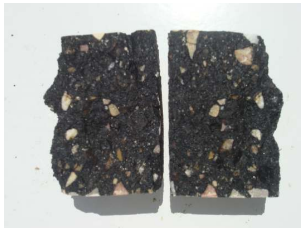
Figura 4. 27: Interior de um carote do Grupo 3, após o ensaio de tracção indirecta.
