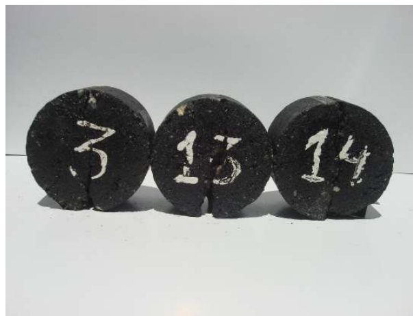
Figura 4. 24: Fracturas resultantes nos provetes do Grupo 3, após o ensaio de tracção indirecta.
