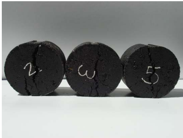
Figura 4. 41: Fissuras de cada provete de laboratório do grupo “molhado”.
