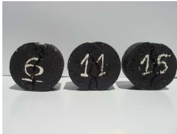
Figura 4. 28: Fracturas resultantes nos provetes do Grupo 4, após o ensaio de tracção indirecta.
