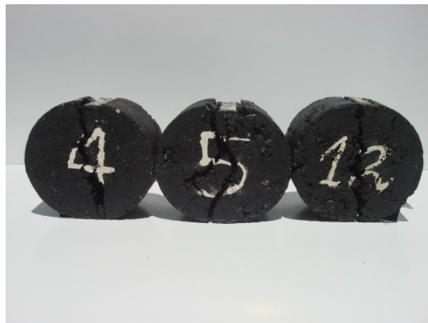
Figura 4. 20: Fracturas resultantes nos provetes do Grupo 2, após o ensaio de tracção indirecta.
