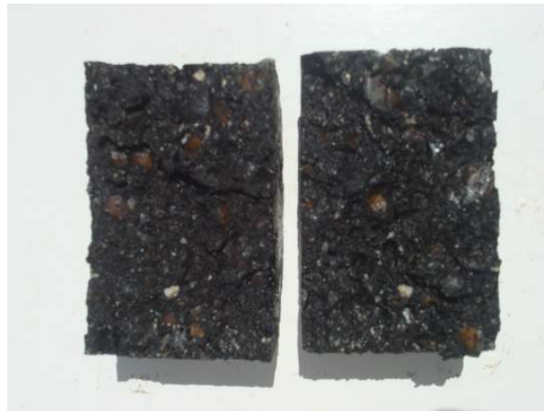
Figura 4. 15: Interior de um provete de laboratório do Grupo 1, após o ensaio de tracção indirecta.
