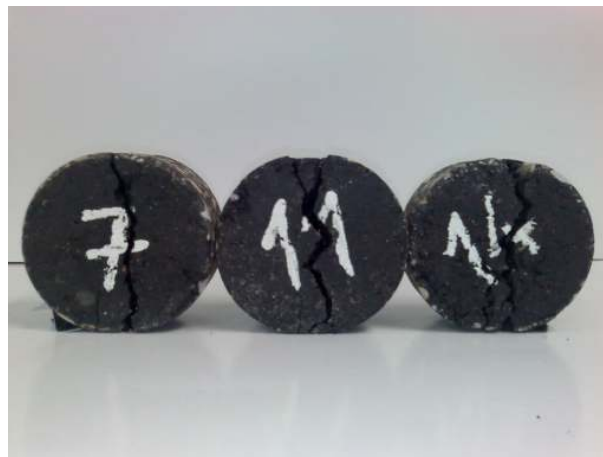
Figura 4. 16: Fracturas resultantes nos carotes do Grupo 1, após o ensaio de tracção indirecta.
