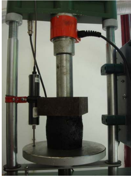
Figura 4. 48: Ensaio de compressão a um provete de laboratório.
