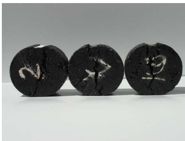
Figura 4. 32: Fracturas resultantes nos provetes do Grupo 5, após o ensaio de tracção indirecta.
