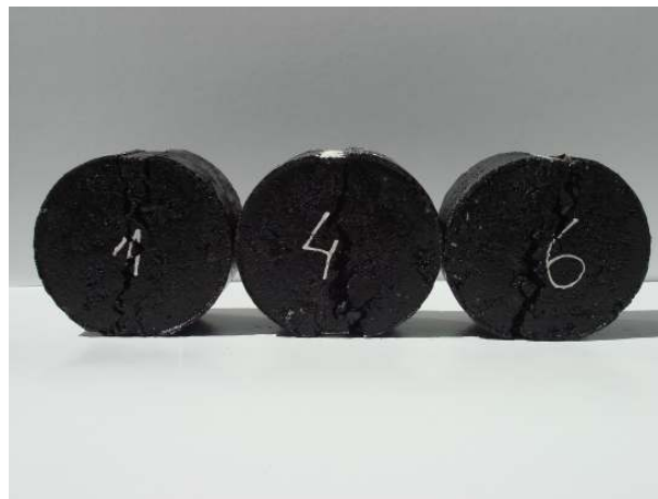
Figura 4. 39: Fissuras de cada provete de laboratório do grupo “seco”.
