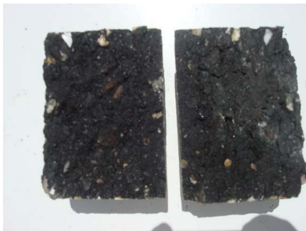
Figura 4. 23: Interior de um carote do Grupo 2, após o ensaio de tracção indirecta.
