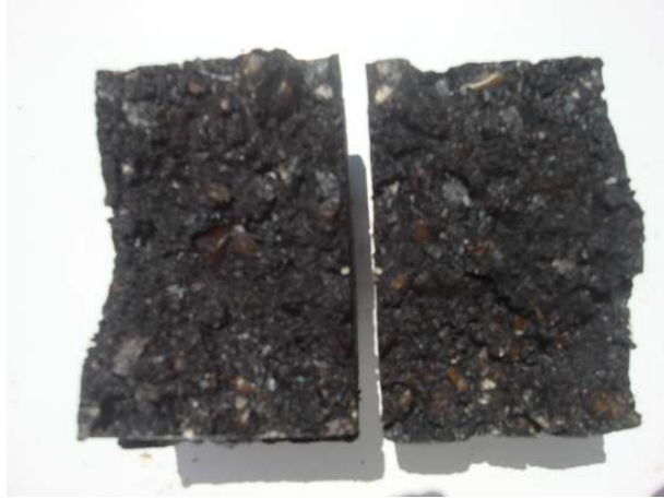
Figura 4. 21: Interior de um provete do Grupo 2, após o ensaio de tracção indirecta.
