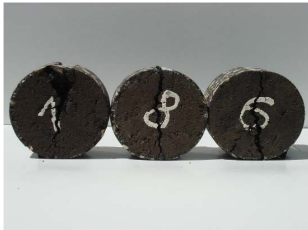
Figura 4. 34: Fracturas resultantes nos carotes do Grupo 5, após o ensaio de tracção indirecta.
