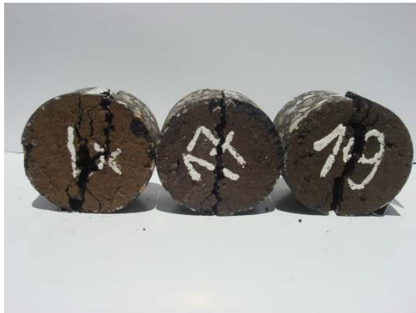
Figura 4. 22: Fracturas resultantes nos carotes do Grupo 2, após o ensaio de tracção indirecta.
