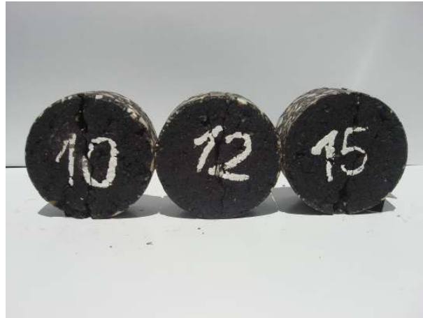
Figura 4. 26: Fracturas resultantes nos carotes do Grupo 3, após o ensaio de tracção indirecta.
