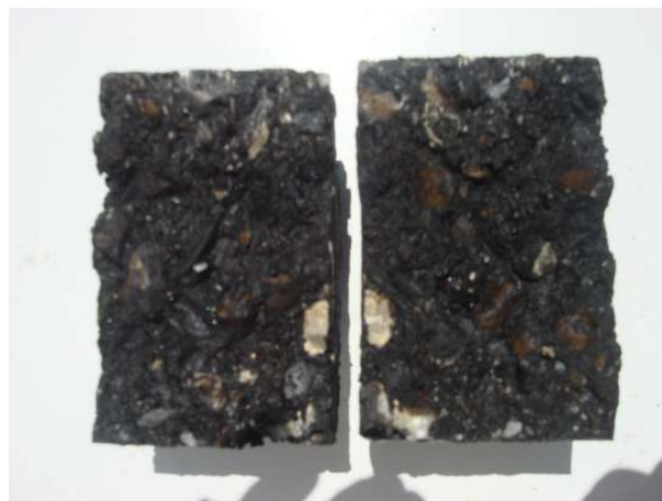
Figura 4. 29: Interior de um provete do Grupo 4, após o ensaio de tracção indirecta.
