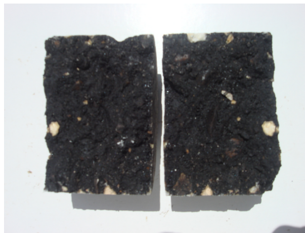
Figura 4. 31: Interior de um carote do Grupo 4, após o ensaio de tracção indirecta.
