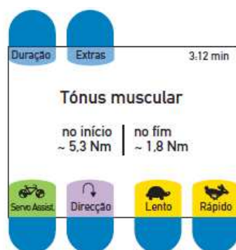
Figura 37 - Possibilidade de apresentação das informações referentes ao tónus muscular, no LCD/TFT do dispositivo APT . Retirado e adaptado de MOTomed (2010).
