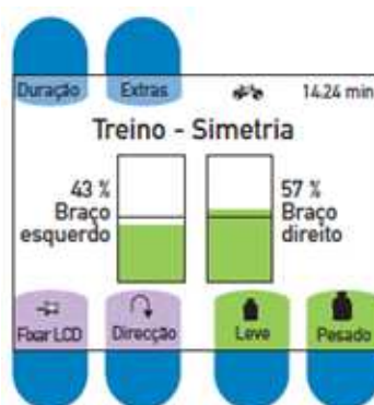
Figura 39 - Possibilidade de apresentação das informações referentes à condição física entre os dois membros superiores, no LCD/TFT do dispositivo APT. Retirado e adaptado de MOTOmed (2010).
