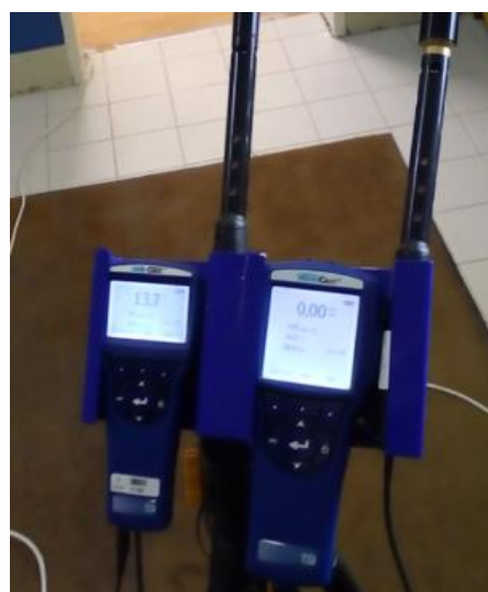
Figura 3.4.2 - Leitura de cov's no interior do edifício
