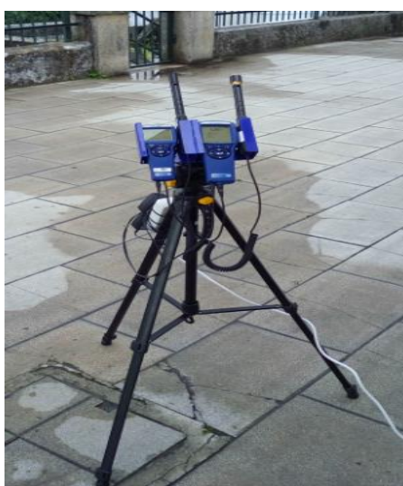
Figura 3.4.1 - Leitura de cov's no exterior do edifício
