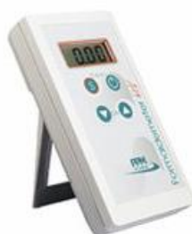
Figura 3.1.2 - Equipamento PPM utilizado na leitura de formaldeído
