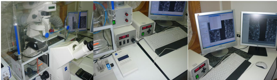
Fig. 30. Microscópio de célula viva Axiovert 200M. E sistemas acoplados que permitem manutenção de condições de crescimento e manutenção celular (5% CO 2 , 37°C) assim como representação, análise e computação de dados.
