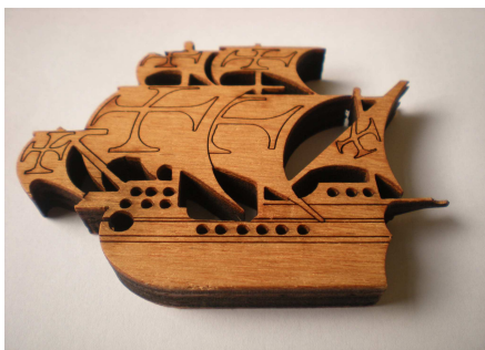
Caravela em laminados de madeira obtida em corte por LASER. O rigor dimensional contrasta com o aspecto rústico dos bordos queimados, ambos requeridos pelo cliente.
