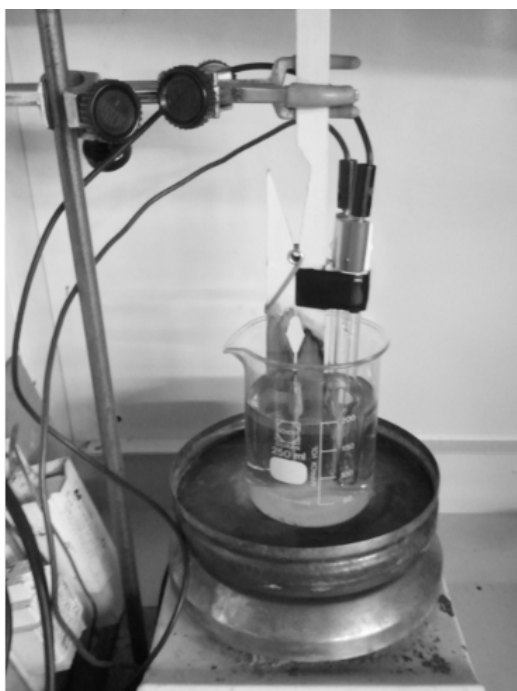
Figura 3.4 - Montagem experimental para a oxidação fotocatalítica
