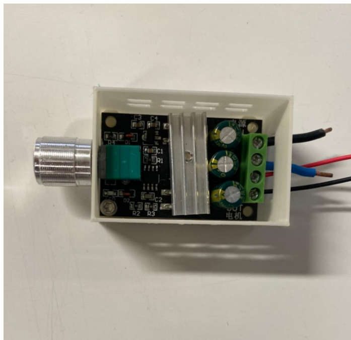
Figura 4.16 - Regulador de velocidade.
