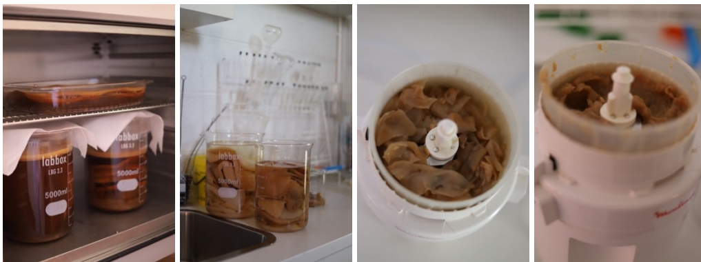
Figura 18– Procedimento de trituração da CB para subsequente utilização na produção dos biocompósitos. Fonte: (Autora).
