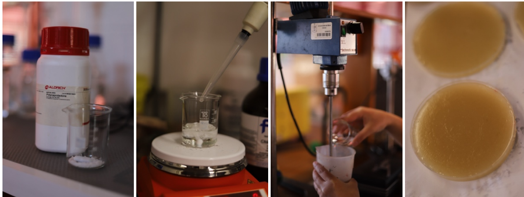
Figura 36– Desenvolvimento dos biocompósitos de CB e alginato de sódio contendo Policaprolactona (PCL) (Experiência 3.A.). Fonte: (Autora).
