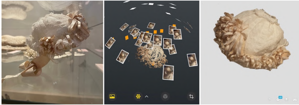
Figura 9: Objeto real, processo de fotogrametria e objeto virtual. Fonte: Investigadora, abril de 2023.
