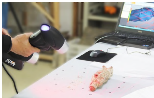
Figura 5: Scaneamento de artefacto de cerâmica Dinastia Wei Oriental, através de um scanner a laser portátil. Fonte: Scantech (2019).
