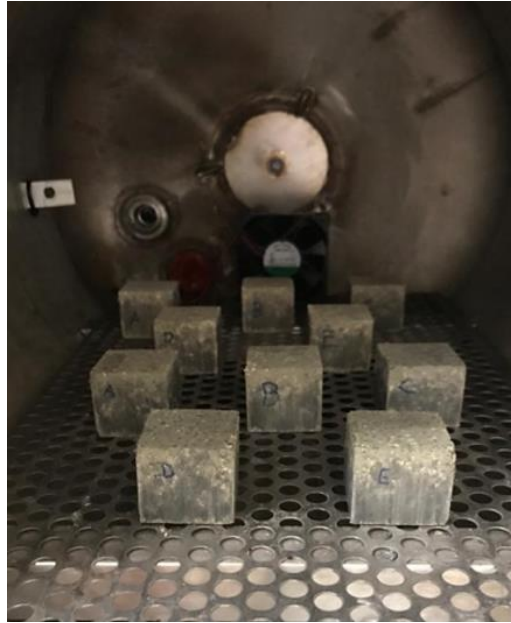
Figura 16: Cubos na câmara de carbonatação depois de 24 horas de carbonatação acelerada.
