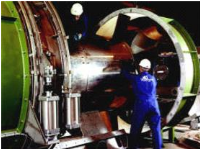
Figura 2.10 - Montagem da turbina eólica da central LIMPET, na ilha de Islay, Escócia [4].
