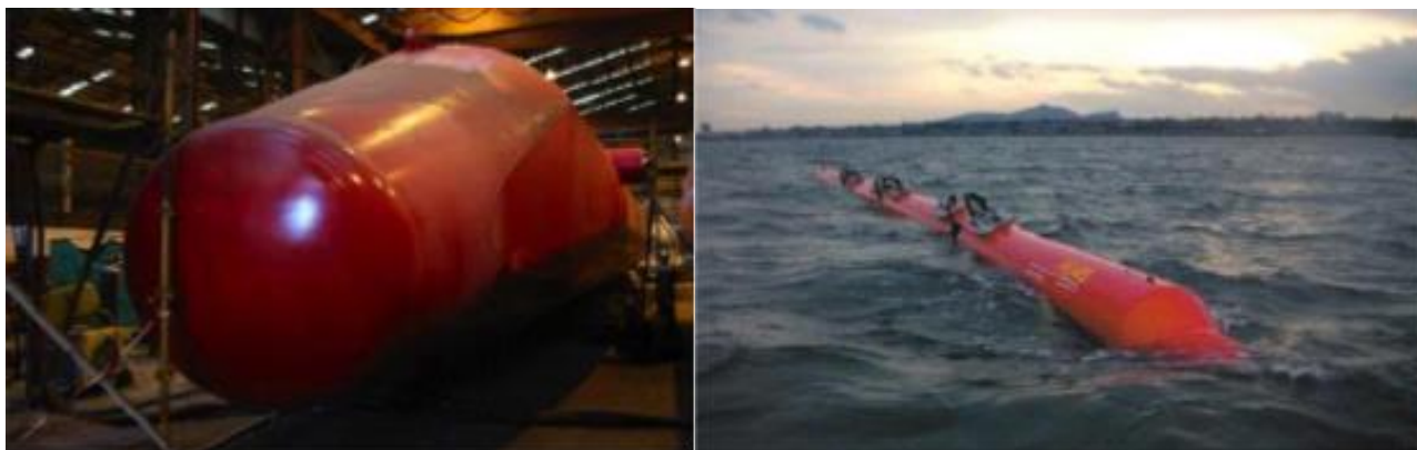
Figura 2.16 - Protótipo de Pelamis de 750 kW. (a): Em construção; (b): Operando em alto mar [4].
