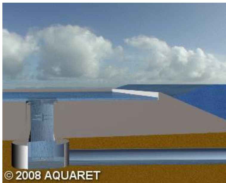
Figura 2.3 - Dispositivos de galgamento [5].
