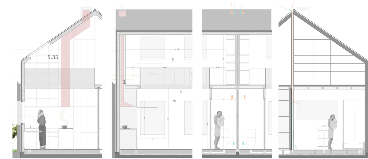
EXTRAÇÃO DE FUMOS E VENTILAÇÃO
