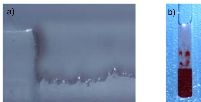
Figura 4.4. a) Fotografia de um reservatório feito a laser, com saliências nas superfícies das estruturas. b) Fotografia de uma estrutura maquinada por ablação a laser. Após a centrifugação do sangue é visível que bastantes células não sedimentam, ficando no meio do plasma agarradas à superfície das paredes e do fundo do reservatório.
