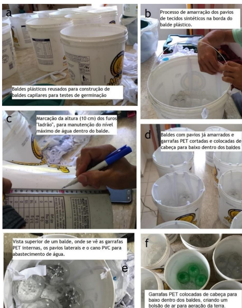
Figura 98 – Diversas fases da construção dos BC2.
