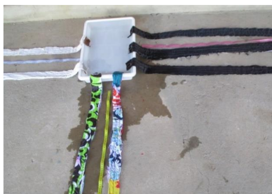
Figura 57 – Exemplo de teste da capilaridade horizontal em fitas.
