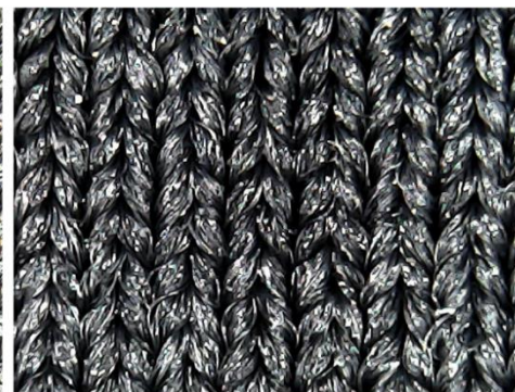
1 mm | Amostra 7 - malha circular 76% Poliamida 24% Elastano
