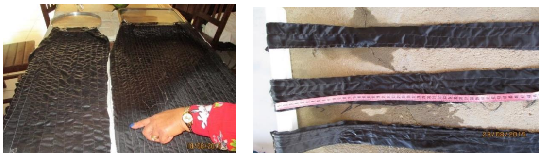
(a) (b) Figura 56 – Testes de campo da capilaridade horizontal: (a) mantas; (b) fitas.
