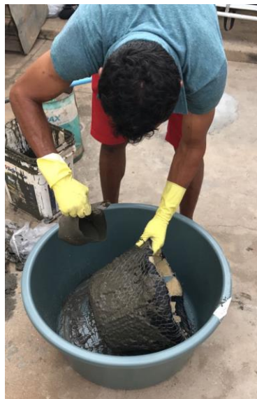
Figura 79 – Processo de fabrico do Baldecap: tela metálica e cobertura de cimento.
