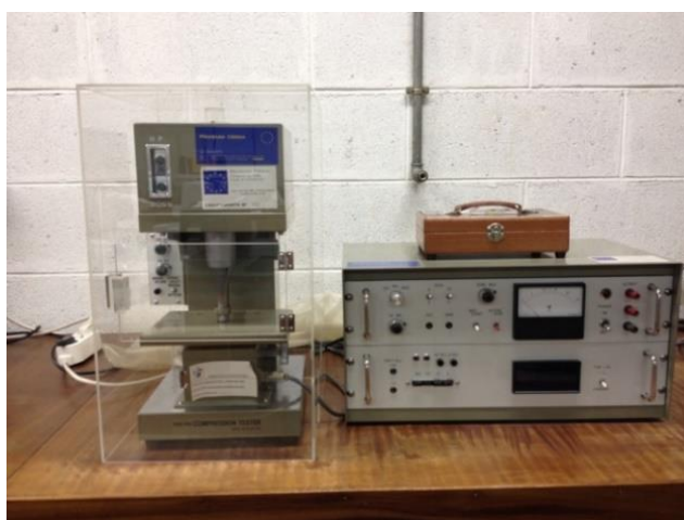
Figura 43 – Teste de compressão - Sistema Kawabata de avaliação de tecidos.
