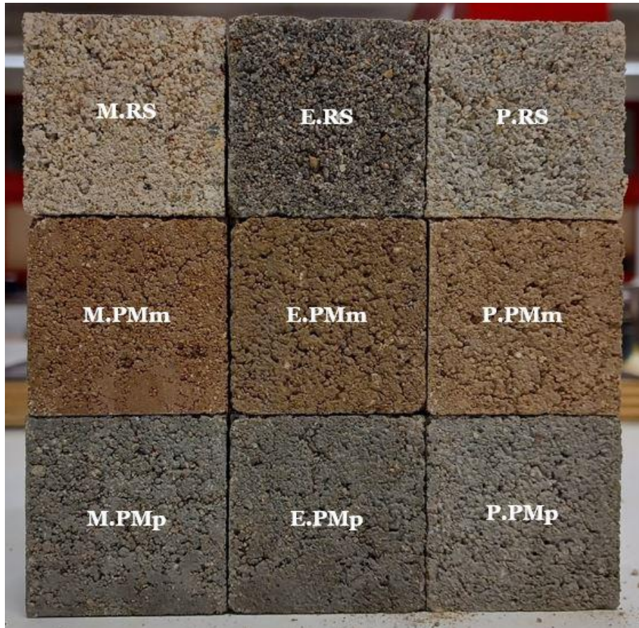
Figura 3-21 – Superfície inferior de um CP das misturas, logo após a cura por carbonatação acelerada.
