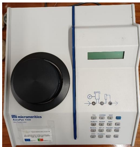
Figura 3-11 - Picnómetro para ensaio de densidade modelo AccuPyc 1330 (Micromeritics).
