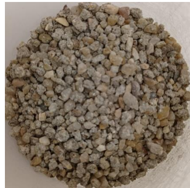
Figura 3-24 – Fragmentos dos CPs com diâmetro mínimo entre a faixa de 2 e 4 mm.
