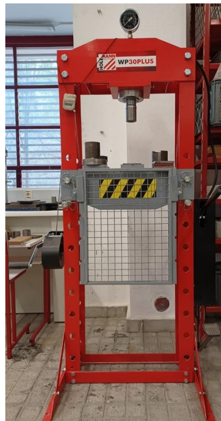
Figura 3-19 – Equipamentos utilizados para compactação dos CPs.
