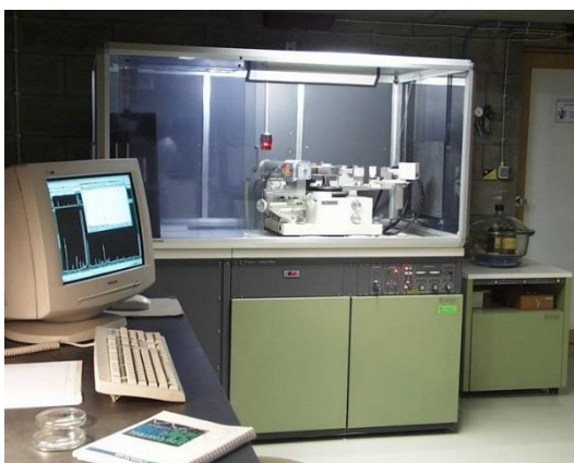
Figura 3-26 – Equipamento de difração de raios X modelo D-Max III/C (Rigaku)[50].
