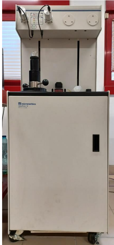
Figura 3-27 – Equipamento de porosimetria por intrusão de mercúrio modelo AutoPore IV 9500 V1.07 (Microporometrics).
