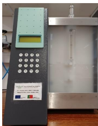
Figura 3-12 - Instrumento Semiautomático de Permeabilidade de Ar BSA1 (Acmel Labo).
