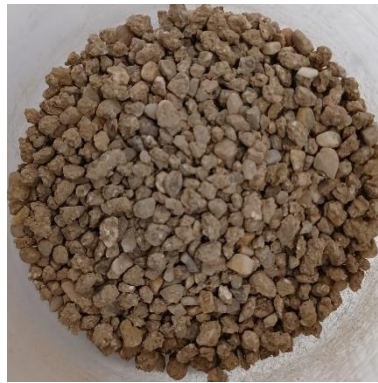
Figura 3-24 – Fragmentos dos CPs com diâmetro mínimo entre a faixa de 2 e 4 mm.
