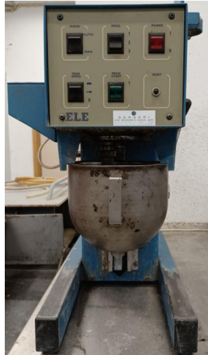
Figura 3-17– Misturador automático de argamassas (ELE International).
