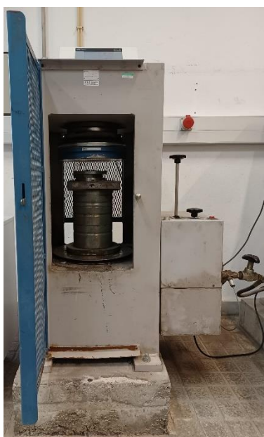
Figura 3-23 – Equipamento para ensaio de resistência à compressão modelo ADR Touch 3000 BS EM (ELE International).
