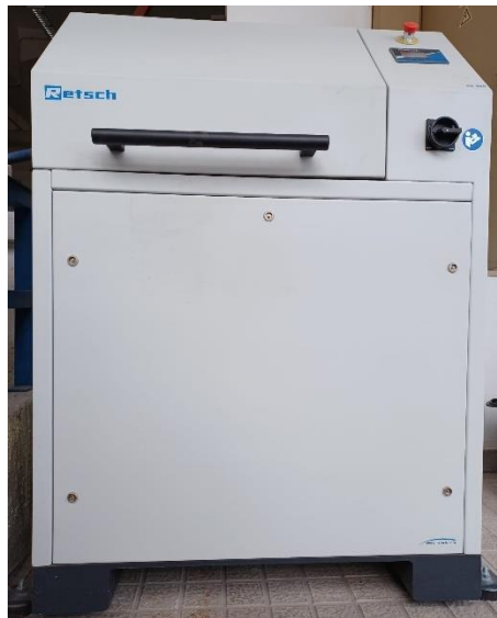
Figura 3-3 – Moinho de disco vibratório RS 300 (Retsch).
