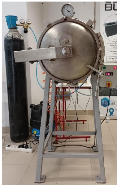
Figura 3-20 – Câmara de carbonatação acelerada.
