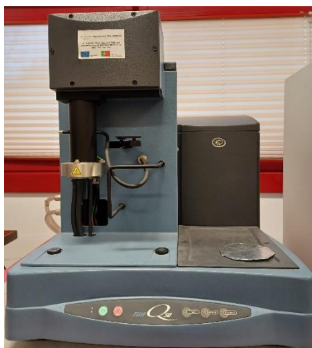
Figura 3-13 - Equipamento para ensaio de termogravimetria SDT Q-50 (TA Instrument).
