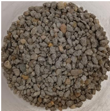
Figura 3-24 – Fragmentos dos CPs com diâmetro mínimo entre a faixa de 2 e 4 mm.
