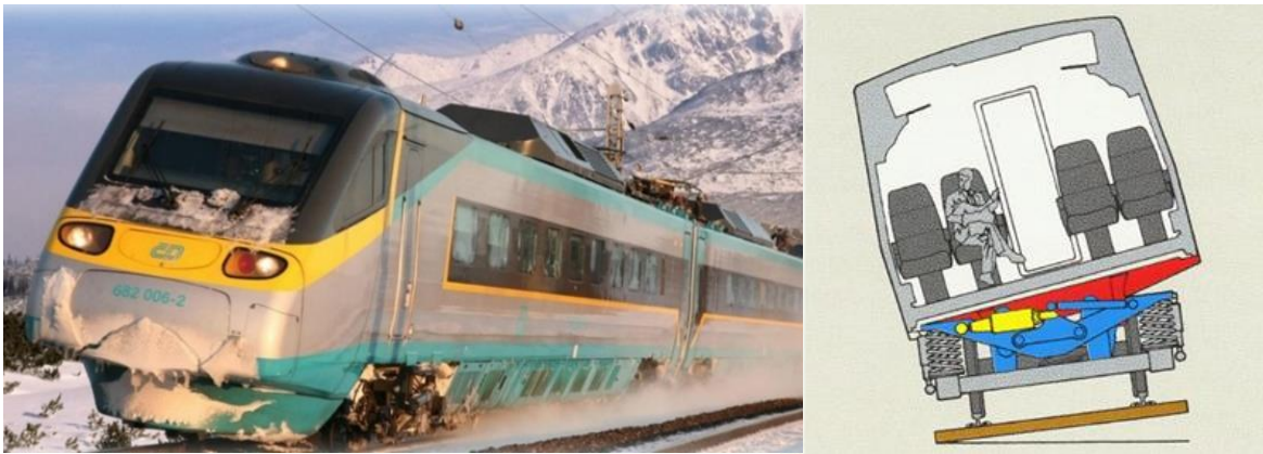
Figura 2 - Exemplo de um sistema europeu de “tilting”[4]
