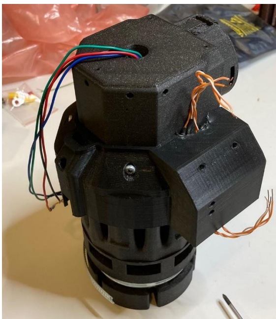
Figura 51 - Cobertura do codificador apertada à estrutura.
