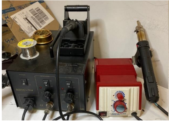
Figura 25 - Estação de Soldadura com ferro e secador.
