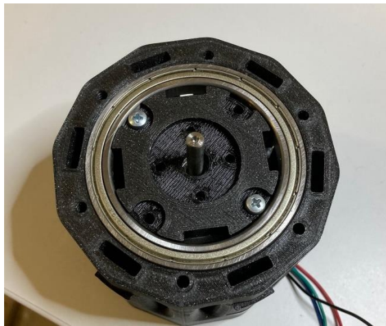
Figura 40 – Coluna da base com um rolamento e motor encaixados.
