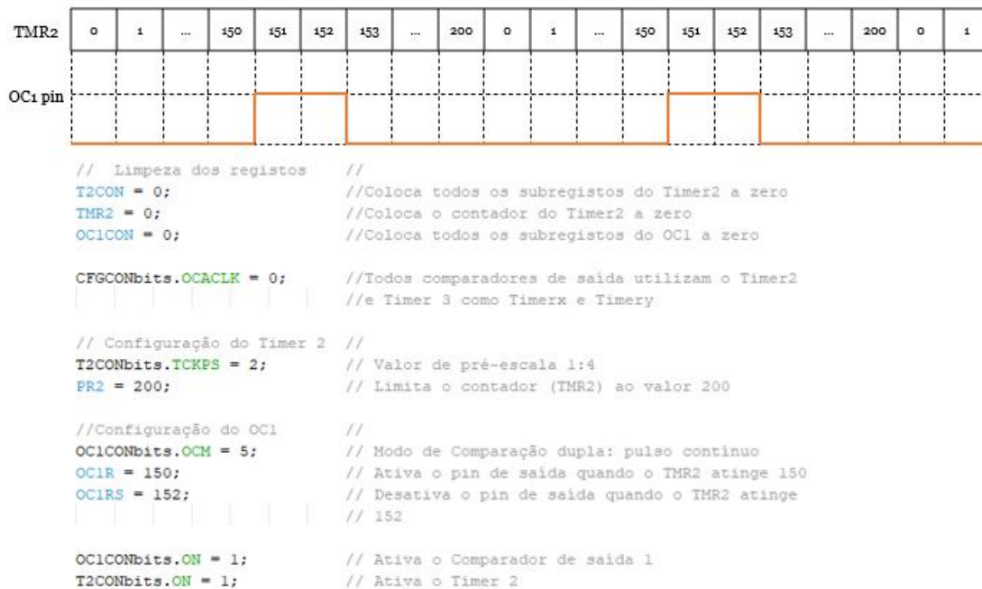
Figura 12. Funcionamento do pino de saída em Modo de Comparação Dupla com pulso contínuo e respetiva configuração. Adaptado de (Microchip Technology Inc., 2011).
