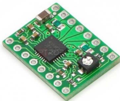
Figura 18. Placa de circuito impresso do Driver A4988 (PTRobotics, n.d.)
