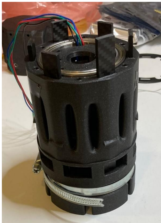
Figura 45 – Base de Montagem inferior já montada na estrutura.
