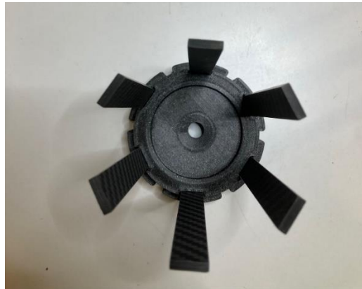
Figura 44 – Base de Montagem inferior com as 6 barras de carbono encaixadas.
