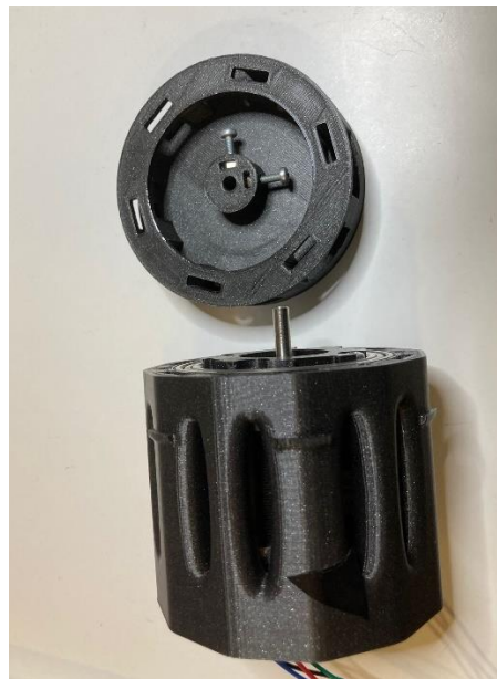
Figura 42 – Base de montagem superior e coluna da base com o motor.
