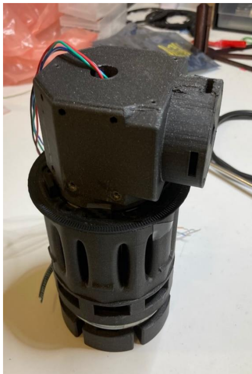
Figura 48 – Pivô já encaixado na estrutura.
