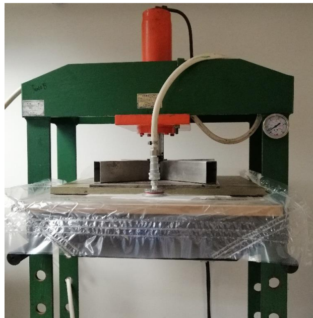
Figura 35 – Laminado no interior do saco, em vácuo e sujeito a pressão, na prensa hidráulica.
