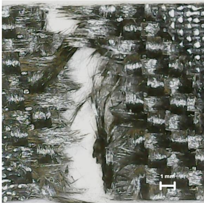
Figura 48 – Fotografia de um provete do laminado de fibras recuperadas a 600°C durante 30 minutos após ensaio de tração.
