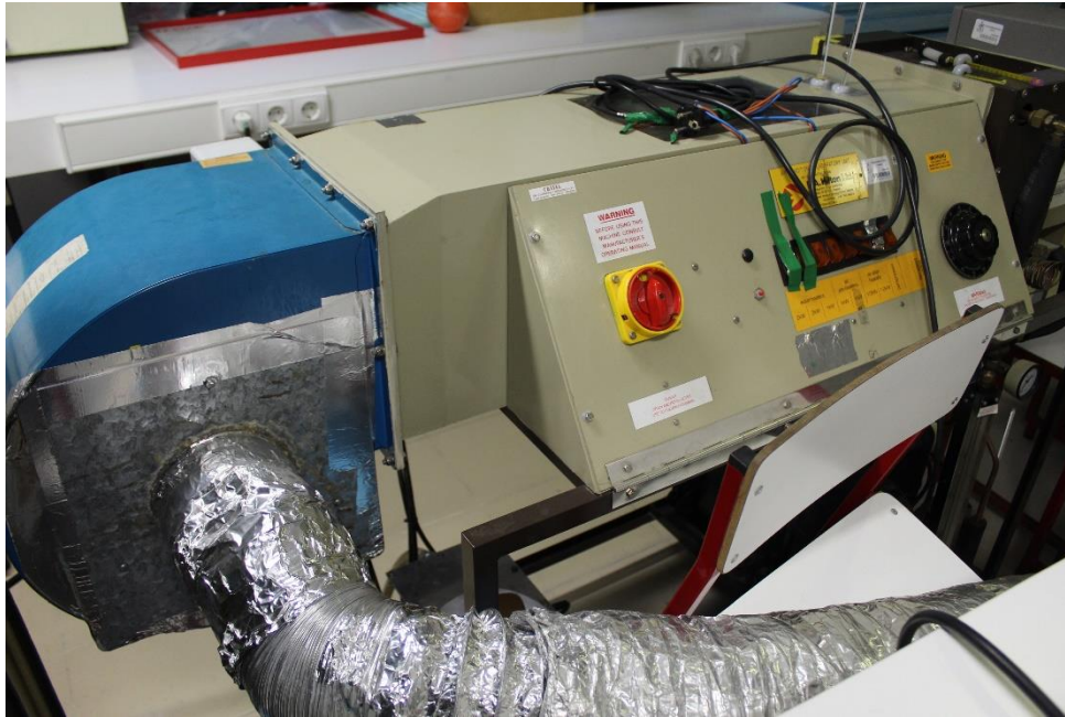
Figura 3.4: Unidade de ar-condicionado PA HILTON A573
