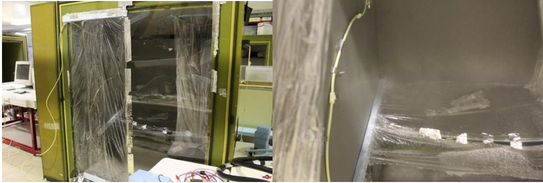
Figura 3.6: Vista geral (esquerda) e vista interior com os nebulizadores em funcionamento (direita) da câmara de humificação de ar
